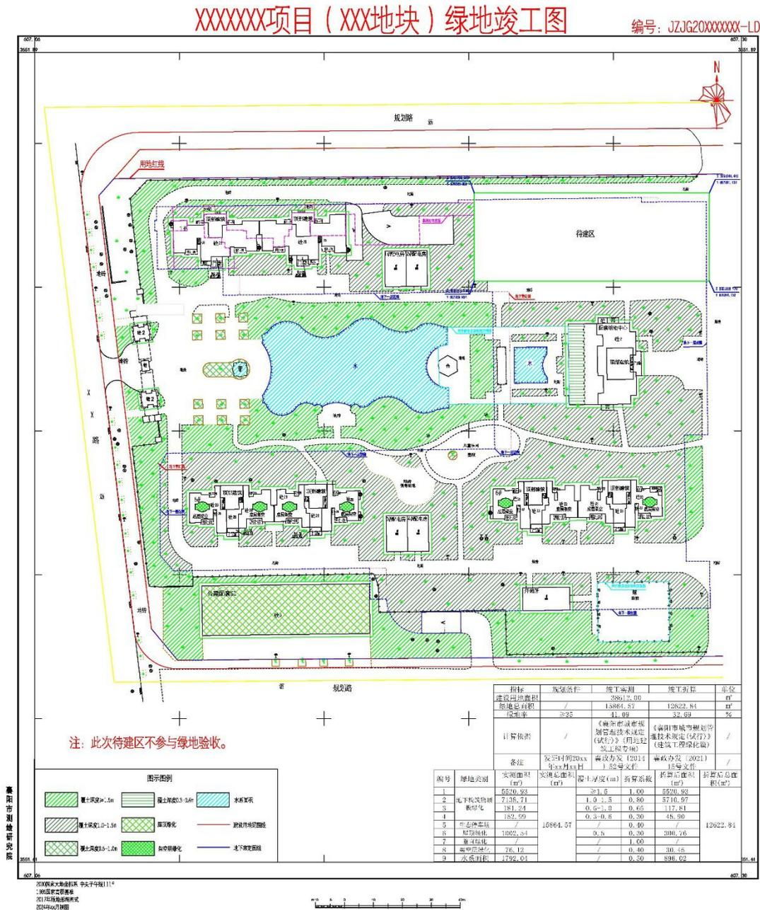
图 B.0.5 绿地竣工测量绿地面积竣工图样式
