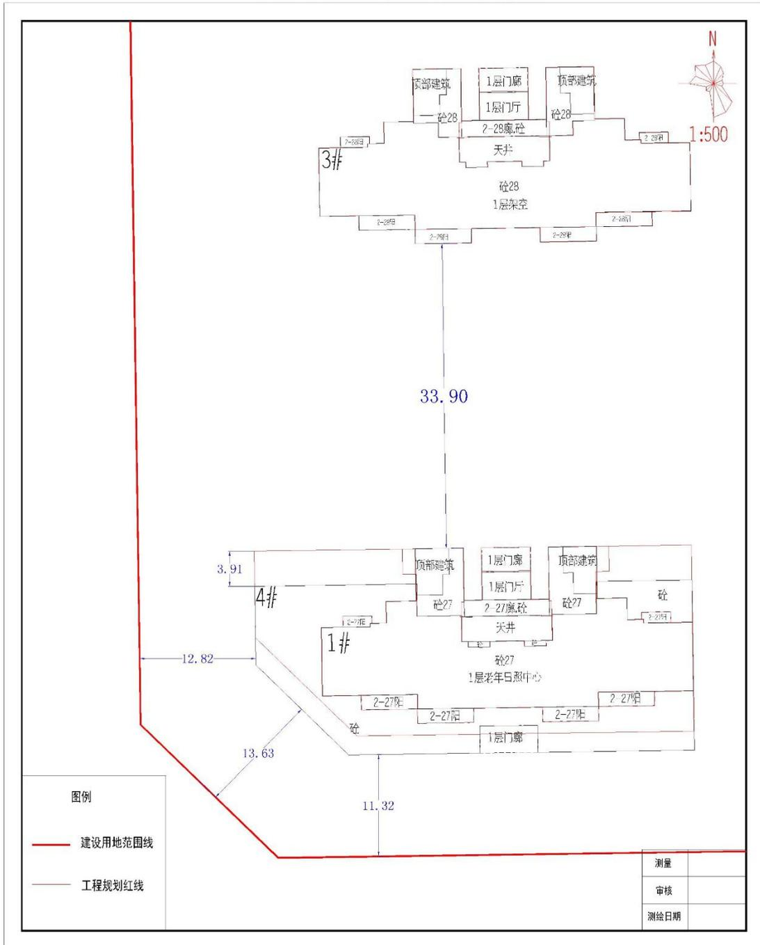
图 A.0.10 建设工程规划核实测量位置、尺寸核实图样式
